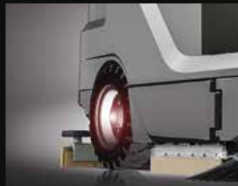
Die Vorder- und Hinterräder sind superelastischen, um die Beanspruchungen auf ein Minimum zu verringern und den Komfort zu erhöhen
