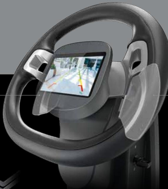
Die Steuerung an den Seiten des Lenkers unterstützen den Bediener. So kann er sich besser auf den Arbeitsbereich konzentrieren, ohne Gefahr zu laufen, abgelenkt zu werden. Der Hebel links dient zur Steuerung des Bürstendrucks, der Hebel rechts aktiviert den Rückwärtsgang. Über das Display überwachen Sie bei Rückwärtsfahrten bequem den rückwärtigen Raum.
