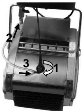
Führen Sie den Bowdenzug unter dem Stiel zum Frischwasserbehälter und schrauben Sie die beiden roten Kunststoffteile (1) zusammen. Achten Sie darauf, dass der Bowdenzug nicht verdreht ist.
